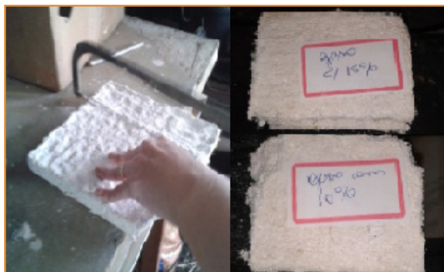
Figura 5 - Corte dos painéis
