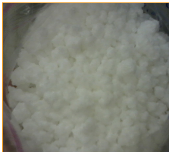
Figura 4 - Imagem do revestimento da ureia com o copolímero (1/1/1/1)
