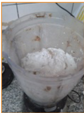
Figura 3 – Mistura de gesso, fibra e água
