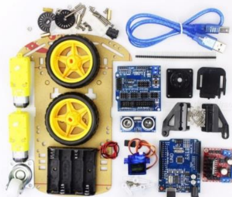
Figura 5 - Componentes do kit de robótica
