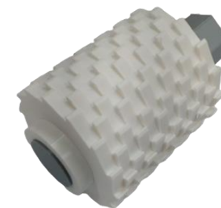
Figura 2 – Cilindro com disposição dos discos de corte.
