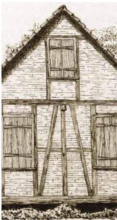
*Construção de tijolos tipo enxaimel*
