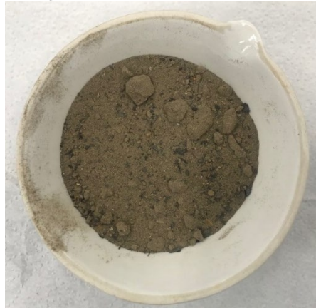
Figura 02: Porção da amostra de cinza utilizada no geopolímero
