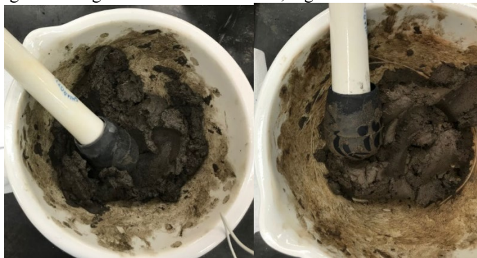
Figura 06: Pasta do geopolímero antes de ser colocada na forma, na primeira imagem somente cinza e argila e na segunda utilizando-se cinza, argila e solo.
