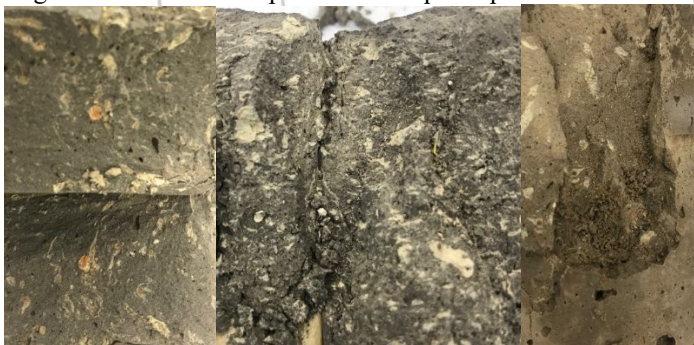
Figura 07: Amostras da pasta matriz após ruptura.
