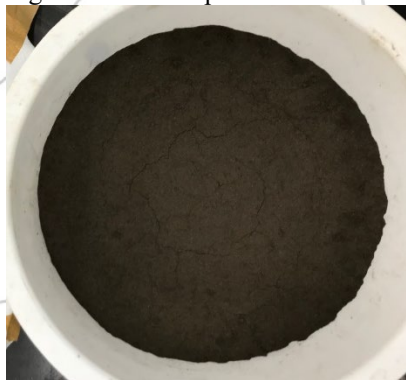
Figura 05: Cinza após ser misturada ao ativador alcalino.
