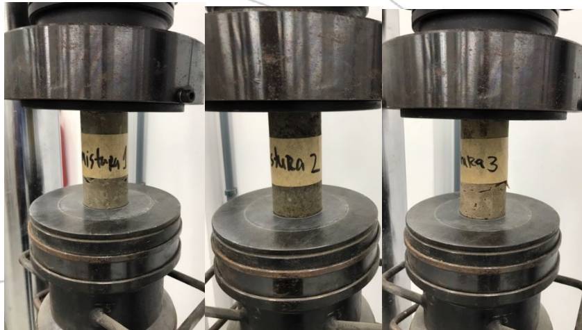
Figura 06: Amostras posicionadas na prensa, aguardando início do ensaio de resistência à compressão
