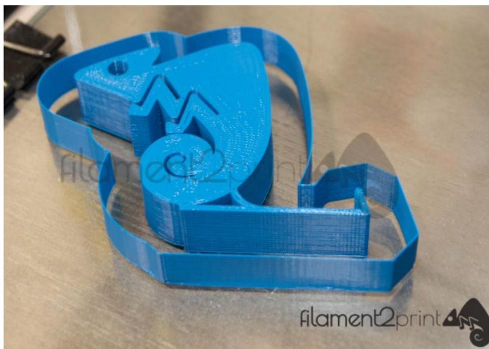
Figura 2: Peça impressa com *skirt*. Fonte: Filament2print.com
