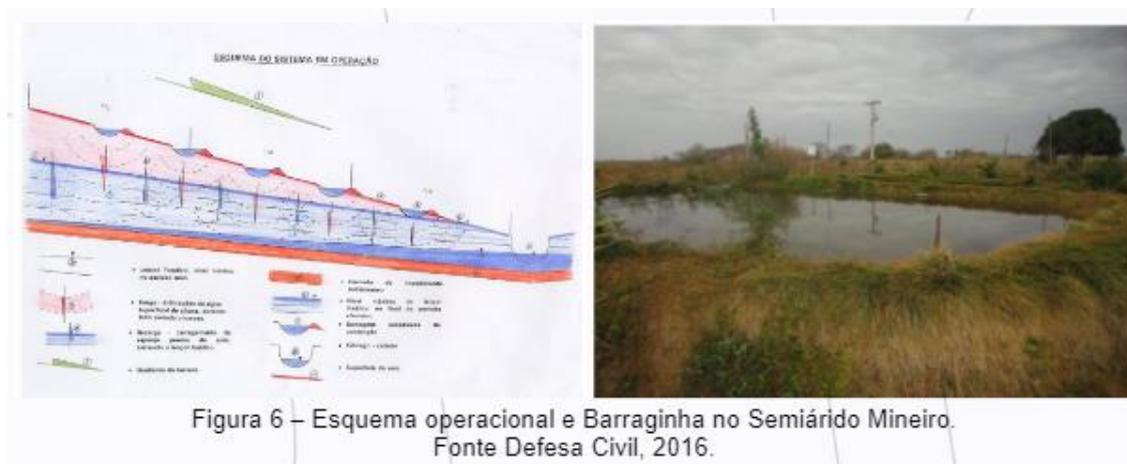
Figura 6 – Esquema operacional e Barraginha no Semiárido Mineiro.
